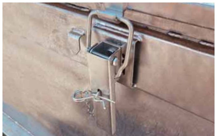
Blocarea capacului - blocată și securizată
